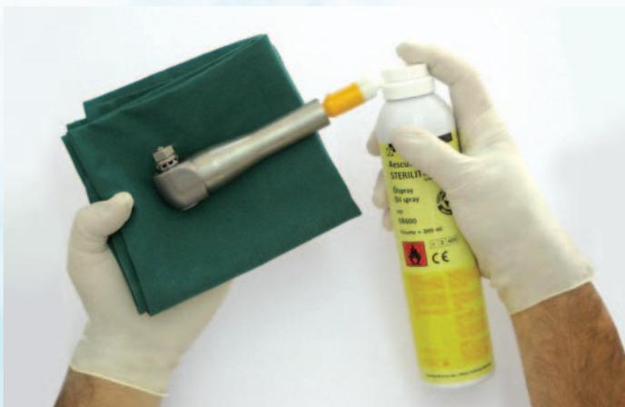
*ej. lubricación del interior de la sierra oscilante micro-line GB129 con Sterilit® GB600 y adaptador GB600810*
